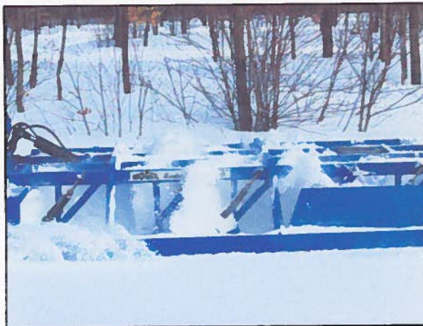
Photo 4.5 Conserver la neige traitée à l'intérieur du traîneau niveleur!
