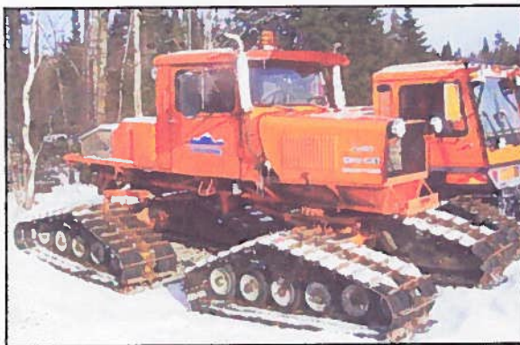
Photo 2.26 Exemple de chenille à traverses en acier
