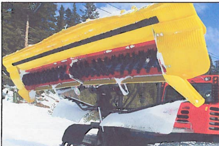
Photo 2.21 Vue de dessous d'un mélangeur
