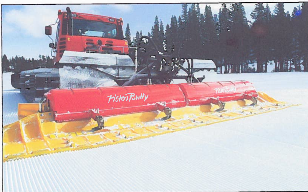
Photo 2.22 Mélangeur flexible réglé en position rigide (droite) à l'aide du dispositif de verrouillage illustré ci-dessous
