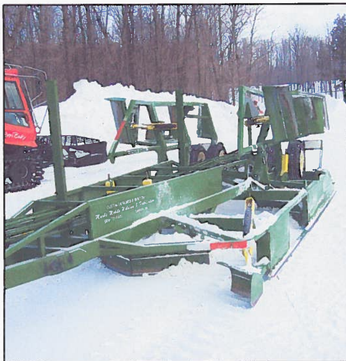
Photo 2.2 Traîneau niveleur équipé d'ailes hydrauliques
