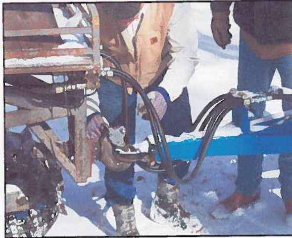
Photo 2.17 Raccords rapides et goupille de cisaillement dans la flèche du crochet d'attelage
