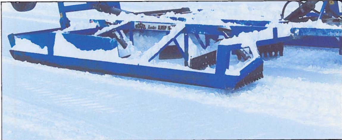
Photo 4.10 Utiliser uniquement les lames arrière de la dameuse lorsqu'il y a peu de bosses sur la piste.
