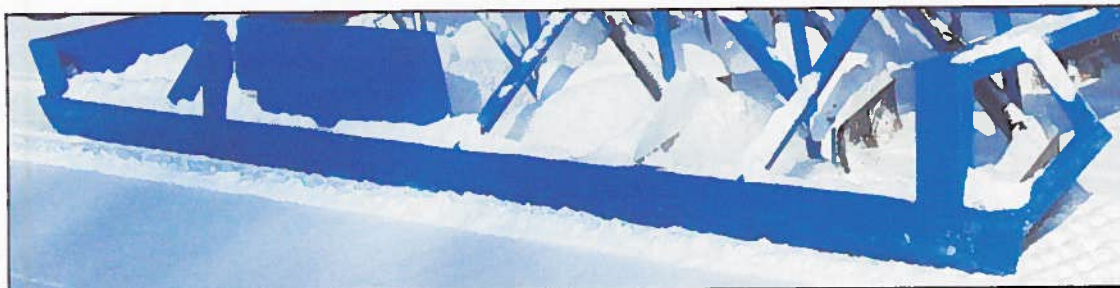
Photo 2.4 Le longeron latéral sur un traîneau niveleur à lames multiples facilite la retenue de la neige dans le traîneau.
