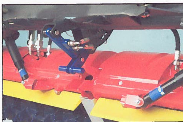
Photo 2.22 Mélangeur flexible réglé en position rigide (droite) à l'aide du dispositif de verrouillage illustré ci-dessous
