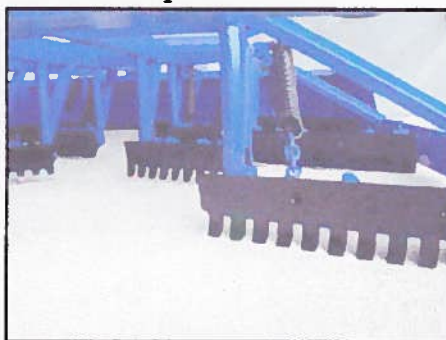
Photo 2.8 Lames de raclages dentelés
