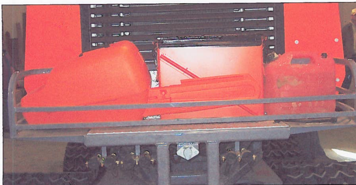
Photo 2.30 Plateforme arrière de type courant utilisée pour le transport des outils, des panneaux de signalisation de rechange et de la réserve de carburant
