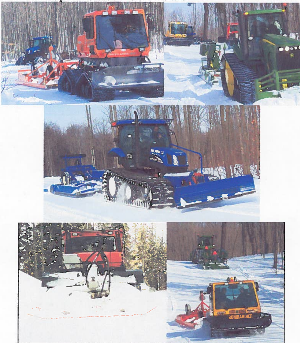
Photo 1.7 Exemples d'équipements de damage de pistes de quads modernes
