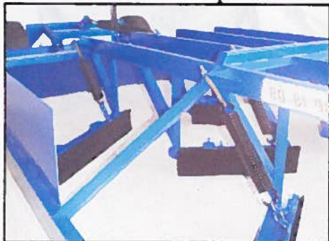
Photo 2.7 Lames de raclage inclinées
