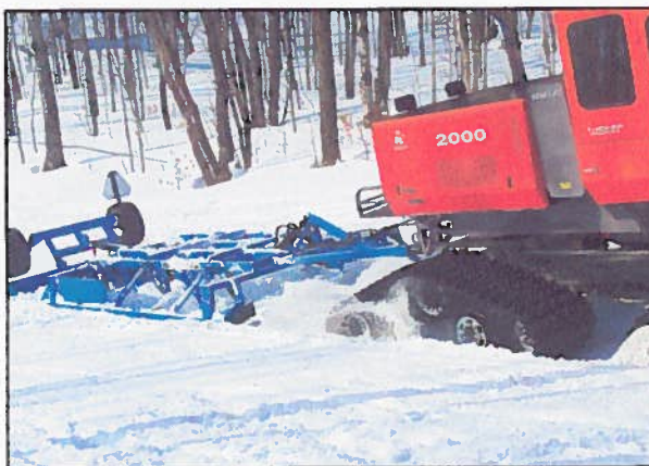
Photo 4.13 Faire attention aux tranchées creusées par des chenilles patinant sur place
