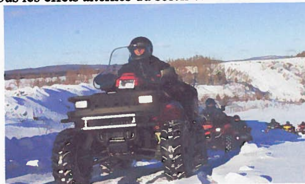
Photo 1.11 Les roues, les pneus, et la suspension d'un Quad Sont autant d'éléments contribuant à la formation de bosses
