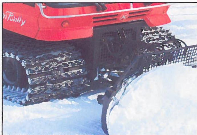
Photo 4.15 Observer l'arrière de la lame avant pour en surveiller la hauteur par rapport à la chenille
